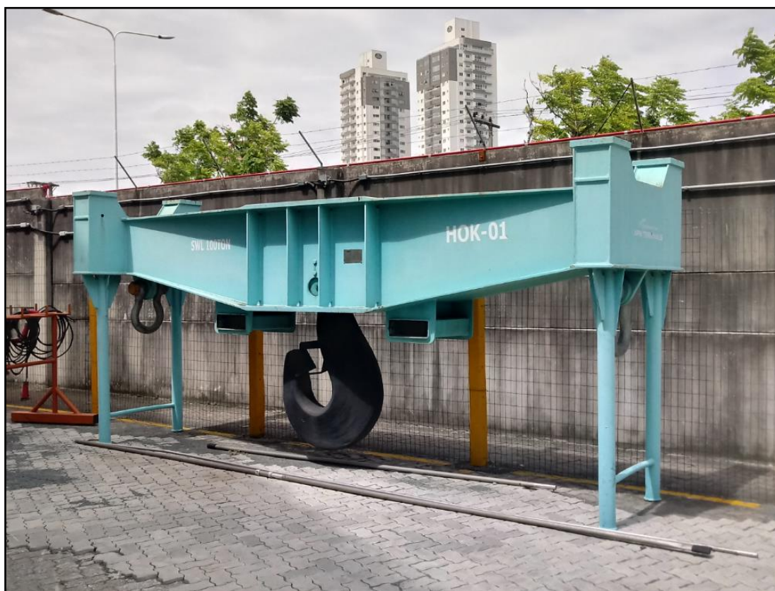
Figura 1. Gancho para carga geral, HOK-01.
